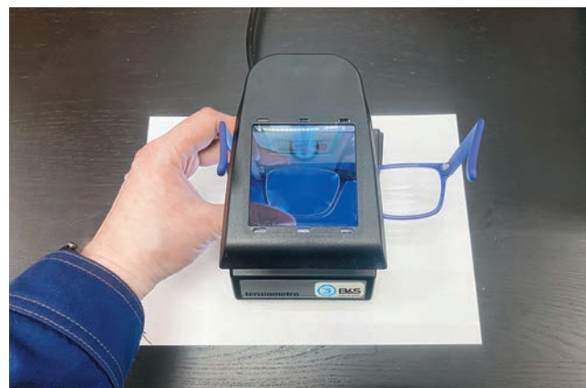
Контроль качества установки линзы в оправу с помощью тензиометра
